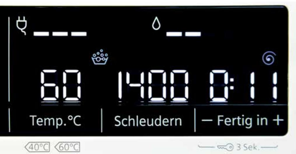
► Das Display ist mit drei berührungsempfindlichen Tasten verknüpft: Mit diesen lassen sich die (Wasch-) Temperatur in °C (**Temp. °C**), die Schleuderdrehzahl in U/min (**Schleudern**) und schließlich die Endzeit des jeweiligen Waschprogramms in h:min (**Fertig in**) verändern.
