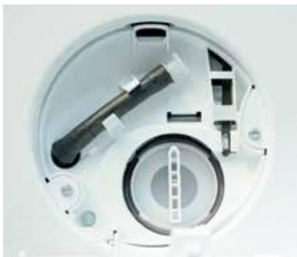
Sollte die Maschine in einer Fehlersituation manuell entleert werden müssen, lässt sich hierzu der Schlauch unter der Serviceklappe verwenden. Hier kann außerdem die Laugenpumpe erreicht werden, aus der sich dann bspw. Fremdkörper herausholen lassen.
