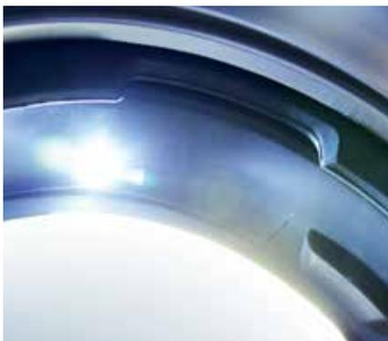
Die **LEDs** leuchten die Trommel einheitlich aus: Selbst bei abendlichen/nächtlichen Lichtverhältnissen lassen sich so alle Textilien erkennen.
