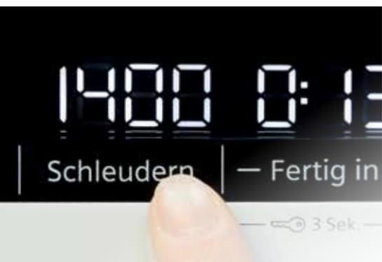
Die Schleuderdrehzahl lässt sich durch Tastendruck (**Schleudern**) anpassen: Maximal 1.400 U/min können verwirklicht werden. Die maximale Schleuderdrehzahl lässt sich aber nicht in jedem Waschprogramm einstellen.
